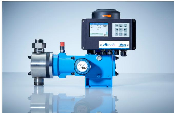
die Hydraulik integrierten, TÜV-geprüften Überdrucksicherung ausgerüstet. Zusätzlich wird durch die neue, intelligente Steuerung auch die Über- oder Unterdrucküberwachung realisiert und eine Vielzahl an Leistungsparametern überwacht. Die Kolben-Membran-Dosierpumpe regelt und überwacht selbständig die vorgegebene Dosiermenge und den Systemdruck. Alle Betriebs- und Störmeldungen werden angezeigt, gespeichert und digital gemeldet. Hervorzuheben ist, dass das Steuerungs- und Regelsystem «iReg»
