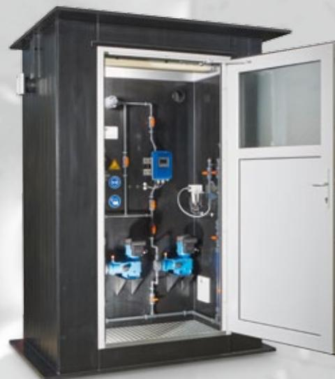
**Aufbaubeispiel 4:** Dosierstation für Eisen(III)-Chlorid eingebaut in einen begehbaren PE-Schutzschrank zur Aufstellung im Freien.
