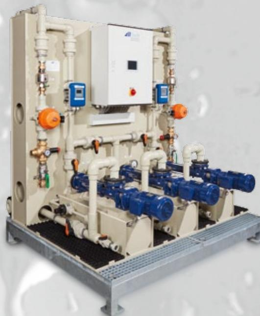
**Aufbaubeispiel 2:** Dosierstation für gebrauchsfertige Polymerlösung mit Exzenterschneckenpumpen, zur Bodenmontage. Komplett betriebsfertig mit Schaltschrank zur Steuerung, Regelung und Überwachung.
