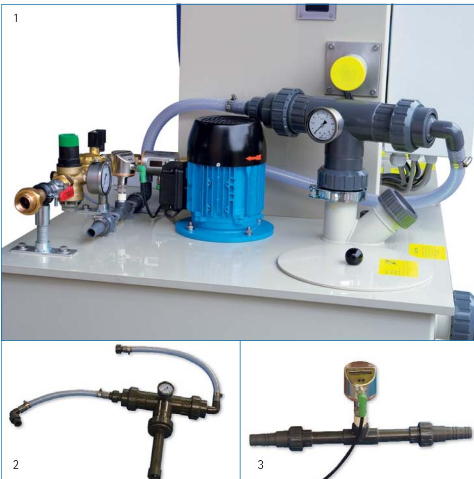
Die Lösewasserapparatur mit Absperrventil, Schmutzfänger, Reduzierventil, Manometer aus Edelstahl mit Öldämpfung und Elektroventil sorgt für einen gleichmäßigen Wasser- eintrag in das Mischsystem. Die Lösungskonzentration wird proportional gesteuert.
